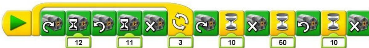
Описание действий: опустить и поднять стропу 3 раза на одну и ту же высоту, затем опустить стропу с паузой 50, которой достаточно, чтобы что-нибудь закрепить на стропе и после этого поднять ее с грузом наверх.
