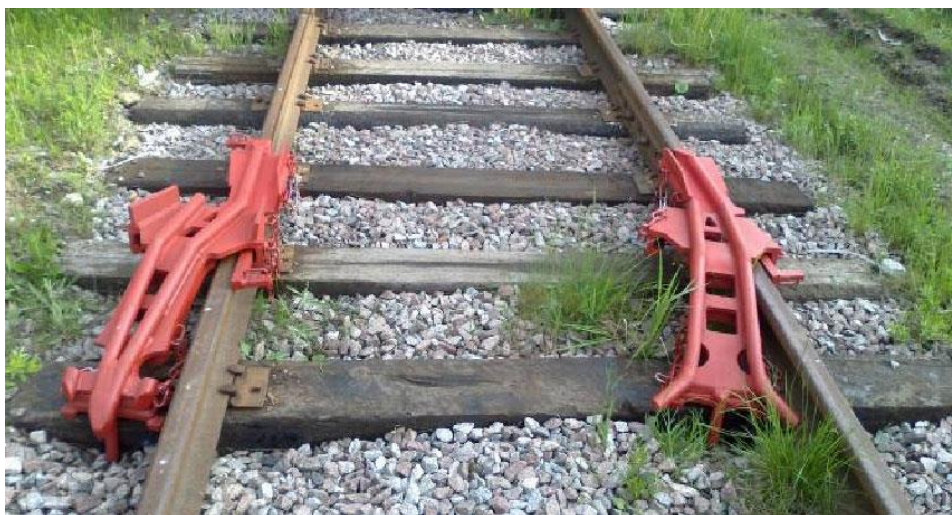
Рис. 2.15. Накаточный башмак «рыбка»
