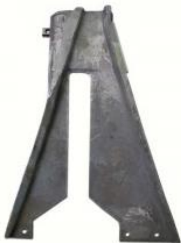
Рис. 2.14. Титановый накаточный башмак «лягушка»
