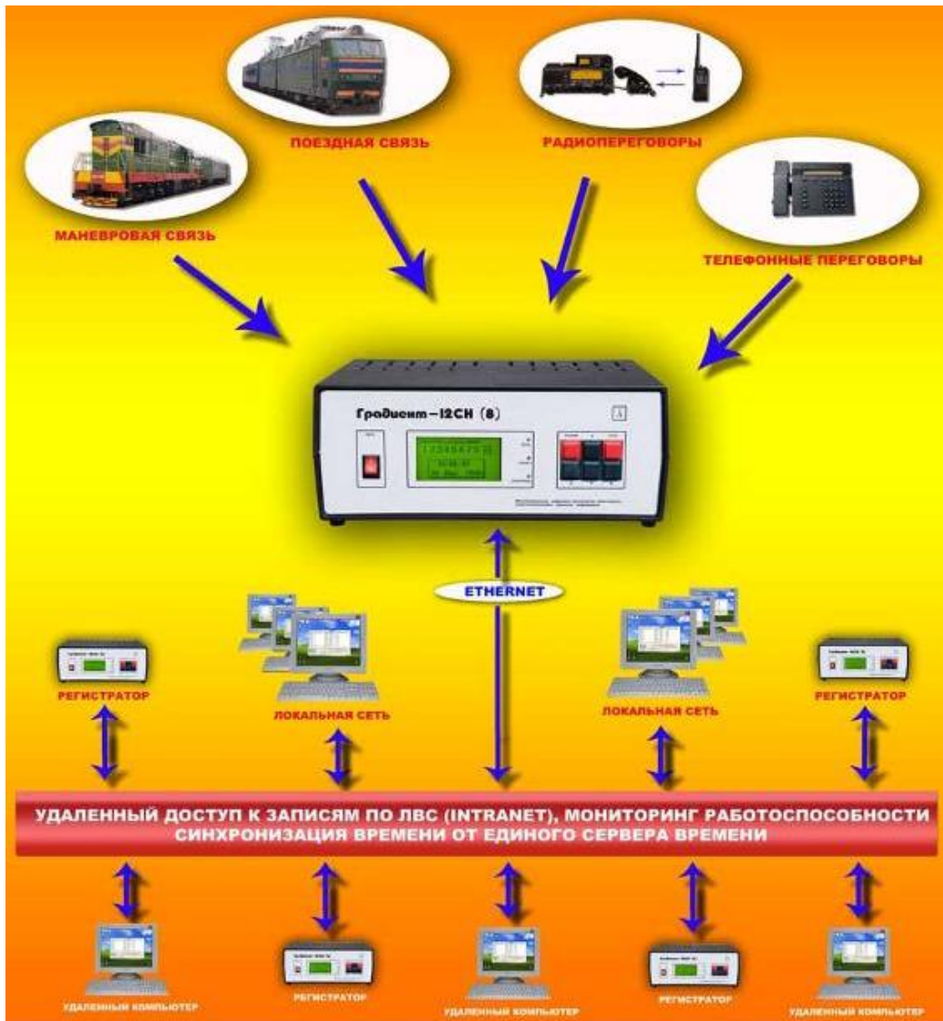
Рис. 8.1. Многоканальный цифровой регистратор переговоров «ГРАДИЕНТ-12СН (8)»
