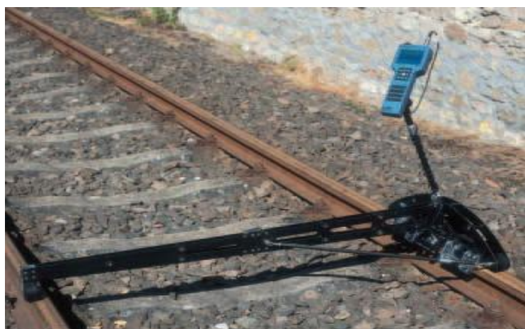
Рис. 4.25. Тележка для ручной диагностики Draisine Light (Draisine + прибор ELOTTEST M2V3) (Германия)
