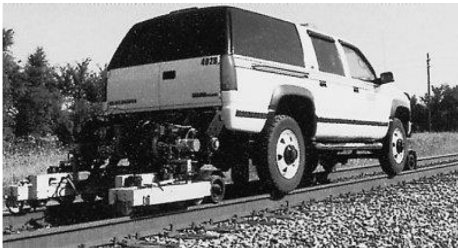
Рис. 4.27. Автомобиль-дефектоскоп на комбинированном ходу компании Herzog Services (США)
