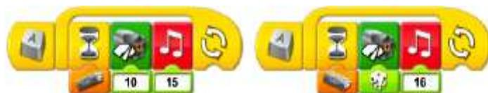
Программа «Спасение самолёта» изменяется, добавляются различные звуки после каждого Блока «Ждать». Первая программа ожидает, когда самолёт поднимет нос, после чего увеличивается мощность мотора до 10 и воспроизводит Звук 15 (мотор). Вторая программа ожидает, когда самолёт опустит нос, после чего изменяет мощность мотора со случайно выбранным числом в диапазоне от 1 до 10 и воспроизводит Звук 16 (глухой). Затем обе программы повторяются.
