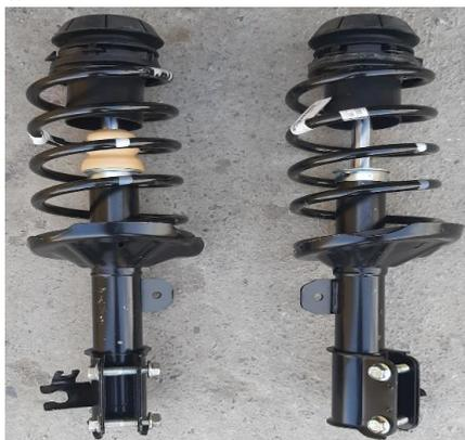
Рисунок 4 - Амортизатор
