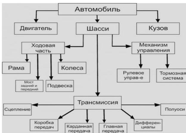
Рисунок 1 - Устройство современного автомобиля
