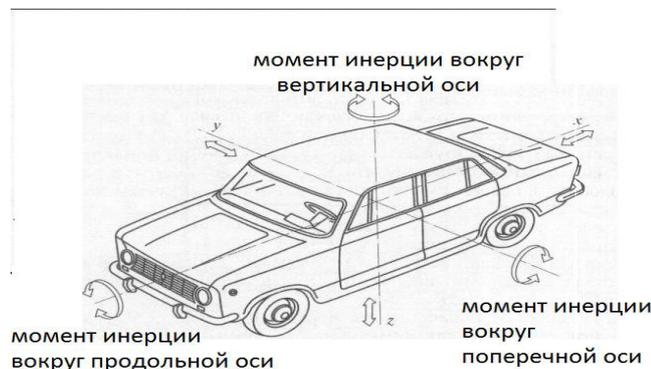
Рисунок 3 - Инерция автомобиля вокруг вертикальной оси
