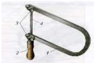
Рис. 1. Ручной лобзик: 1 – рамка; 2 – ручка; 3 – зажимные гайки; 4 – пилка. [ЛЗ]
