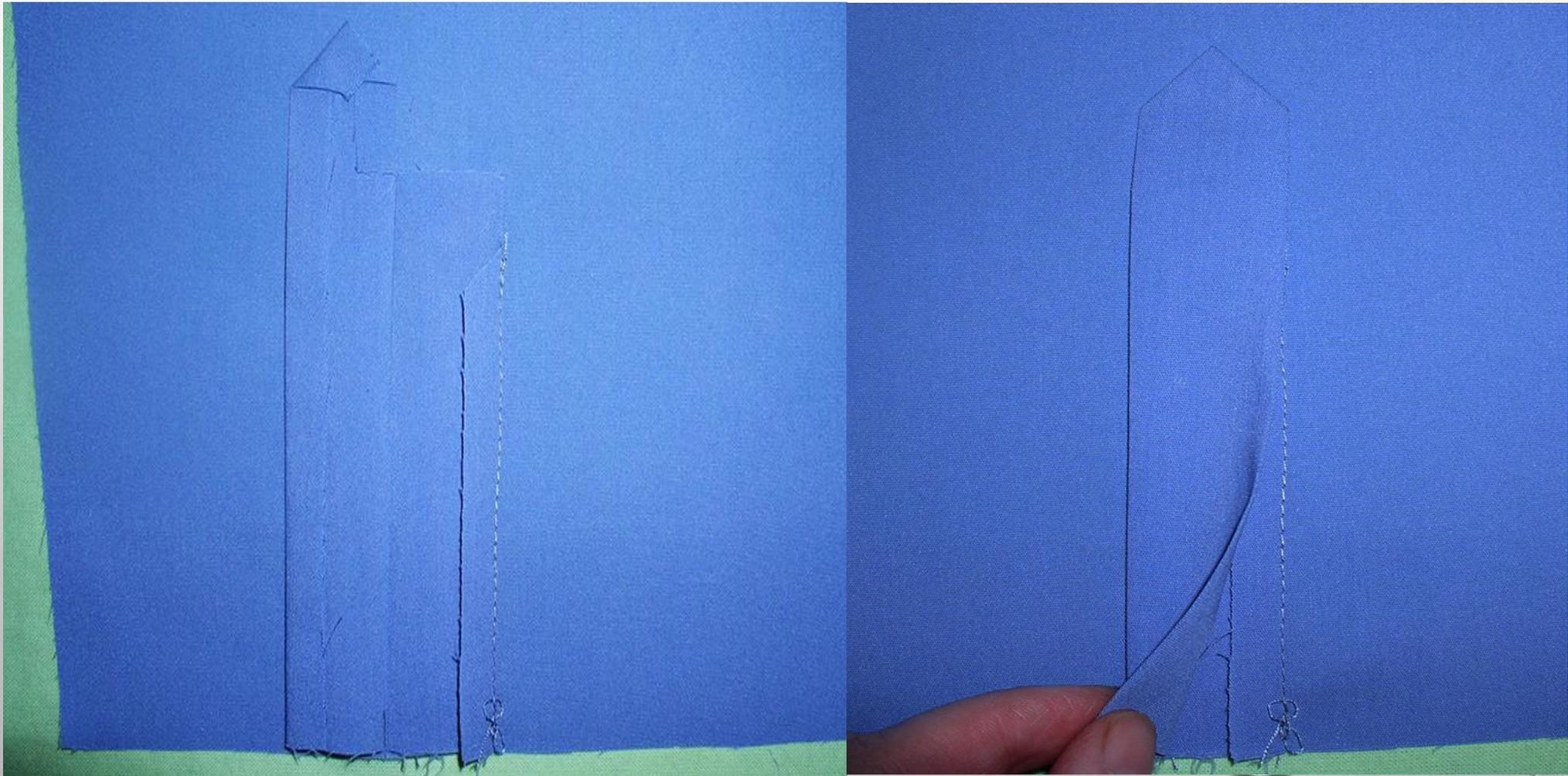
**НАСТРОЧИТЬ ПЛАНКУ С ВЫСТУПАЮЩЕЙ ФИГУРНОЙ ЧАСТЬЮ, ШИРИНОЙ ШВА 0,1СМ. ОТ ПОДОГНУТОГО КРАЯ ПО ФИГУРНОМУ КОНТУРУ, ВЫПОЛНЯЯ ЗАКРЕПКИ В НАЧАЛЕ И В КОНЦЕ СТРОЧКИ, КАК ПОКАЗАНО НА РИСУНКЕ**
